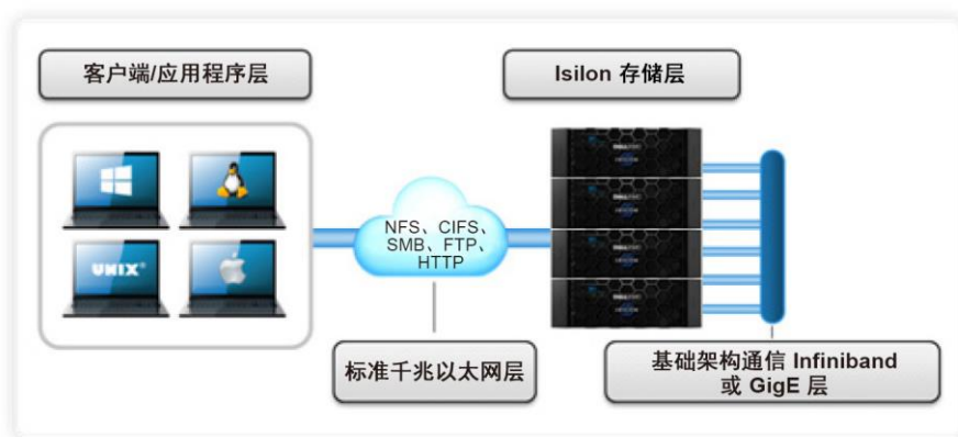
图 1: Isilon 横向扩展 NAS 体系结构
