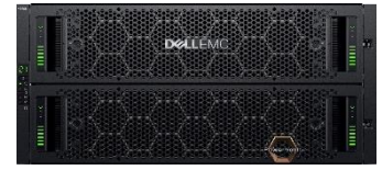
ME484 扩展存储模块 (84 驱动器) 3.5" 驱动器插槽, 5U
