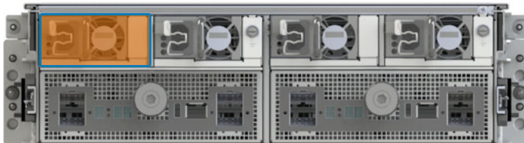
Рис. 1 Неисправный источник питания В0 — пример расположения
