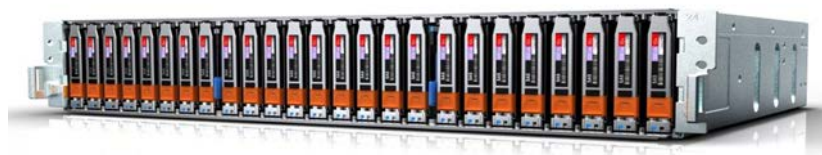
Рисунок 1. Заполненная дисковая полка модуля V-Brick в VMAX 250F
