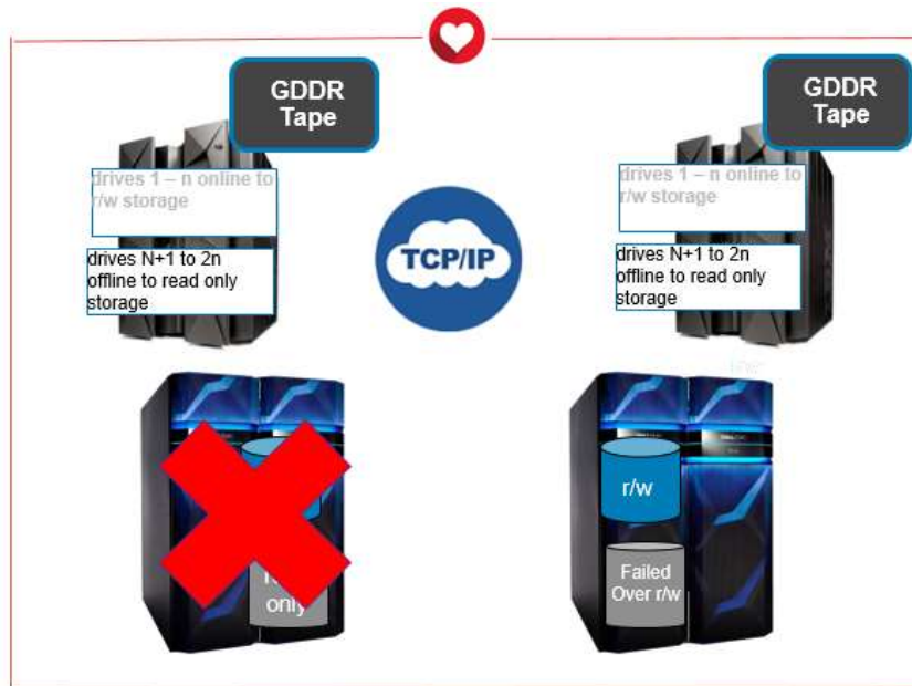
Figura 3. Uso da fita de GDDR para automatizar o failover de locais
