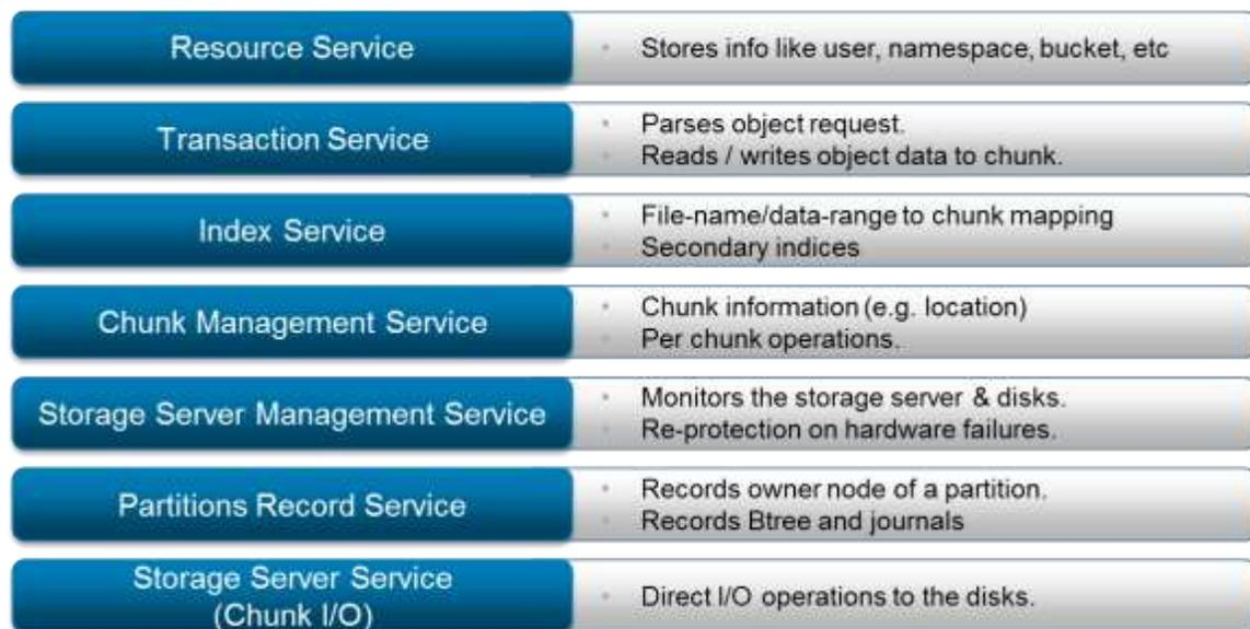
Figura 6 Serviços do mecanismo de armazenamento
