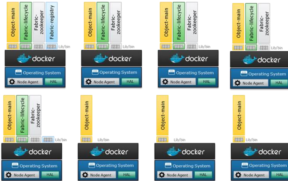
그림 13 8 노드 구축에서의 Docker 컨테이너 및 에이전트 예시
