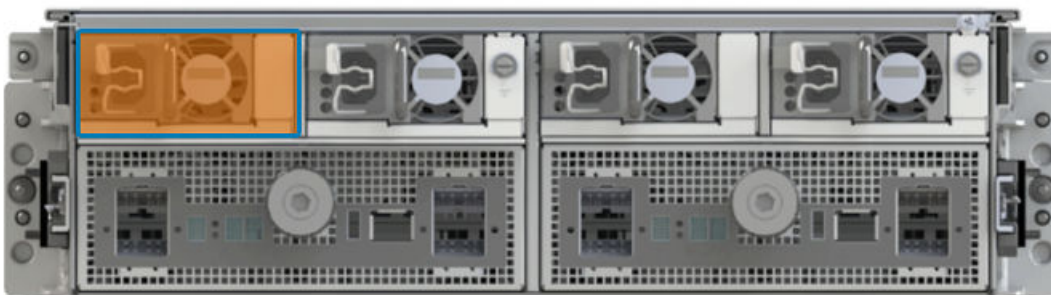
図 1 障害が起きた電源 B0 : 場所の例
