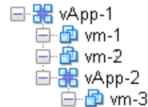
図 6 ネストされたコンテナ構造の例
