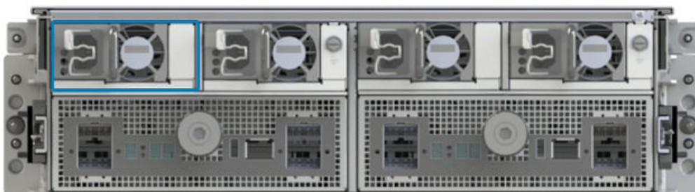
Figure 7 Bloc d'alimentation de remplacement B0 - exemple d'emplacement
