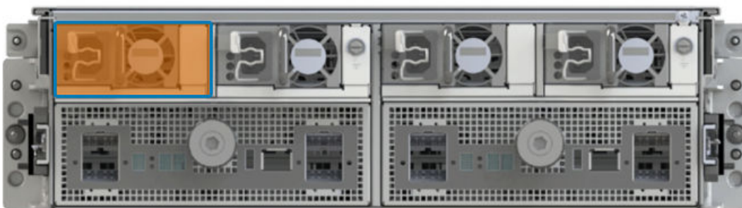
Figure 1 Alimentation B0 en échec - exemple d'emplacement
