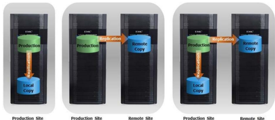
Figure 1 : Illustration de la réplication locale et à distance, et des deux modes de réplication simultanés pour la protection de deux sites
