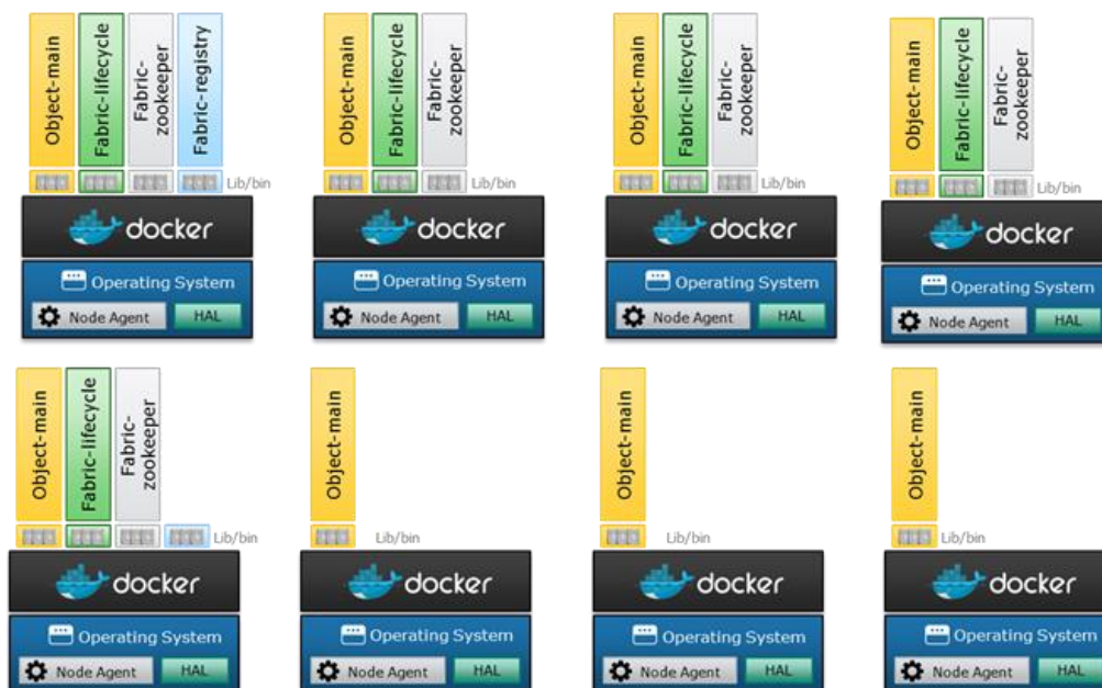
Figure 13 Conteneurs Docker et agents dans un exemple de déploiement à huit nœuds
