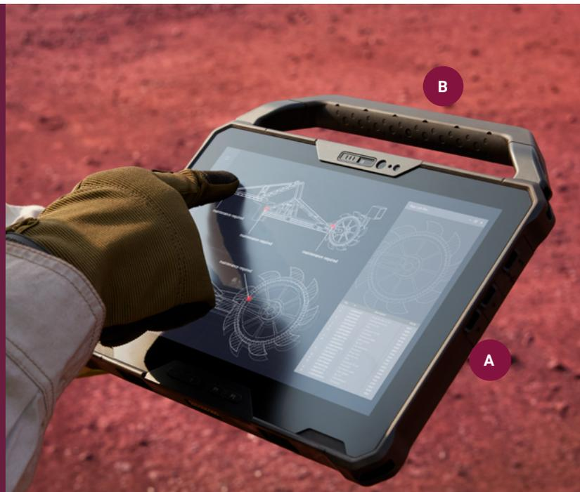
Solución reforzada que proporciona un rendimiento óptimo en las condiciones más rigurosas, con procesadores potentes y baterías intercambiables en caliente.
