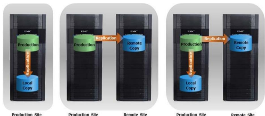
Figura 1: Ilustración de la replicación local, la replicación remota, y la replicación simultánea local y remota
