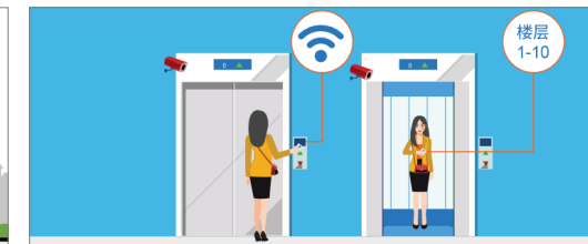
他们使用自己的工牌进入停靠他们所在楼层的电梯。
