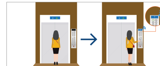
员工再次使用自己的工牌，在电梯中刷卡选择楼层。
