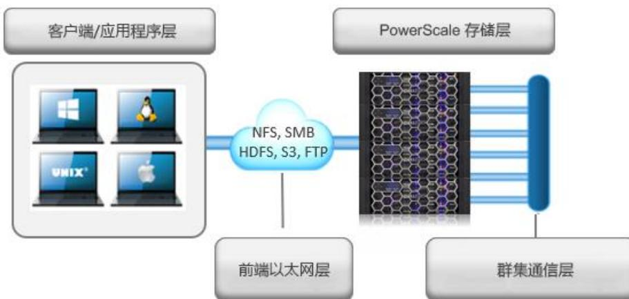
图 1: Dell EMC 横向扩展 NAS 体系结构
