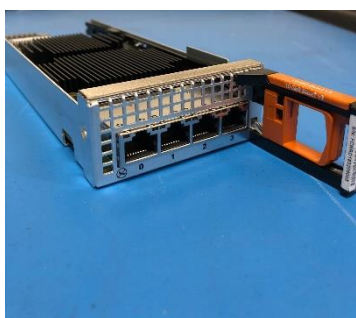
图 34. 10 GbE Base-T I/O 模块
