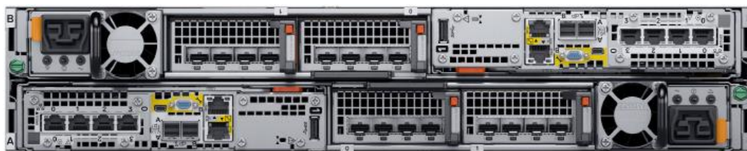
图 12. 基础存储模块背视图
