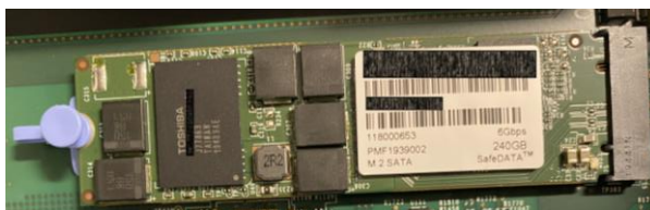
图 20. 内部 M.2 启动模块
