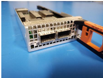
图 31. 100 GbE 光纤 I/O 模块
