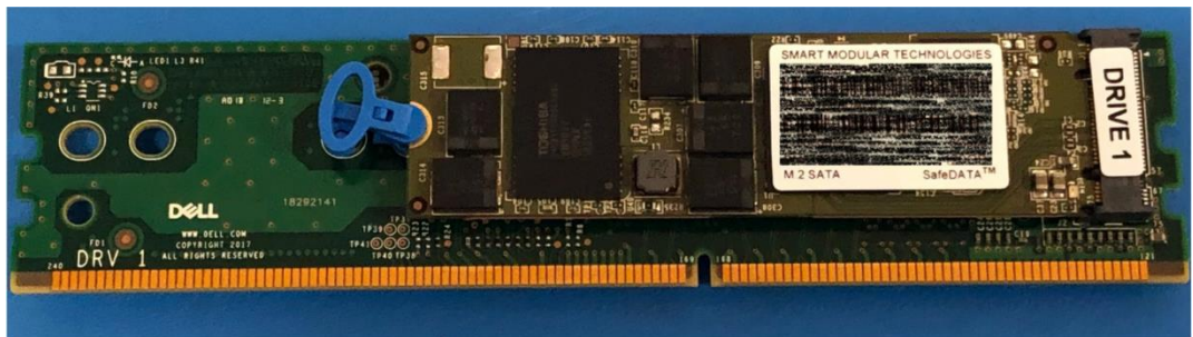
图 4. 内部 M.2 启动模块
