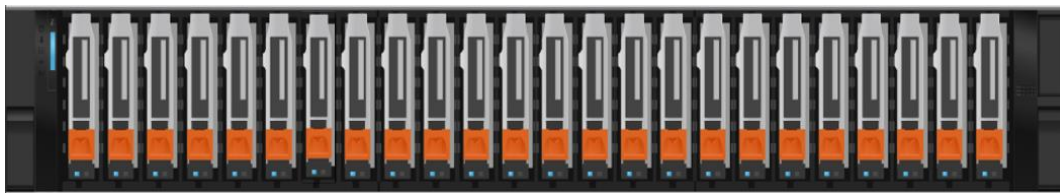
图 27. 24 驱动器 2.5 英寸 2U NVMe 扩展柜 (正面)
