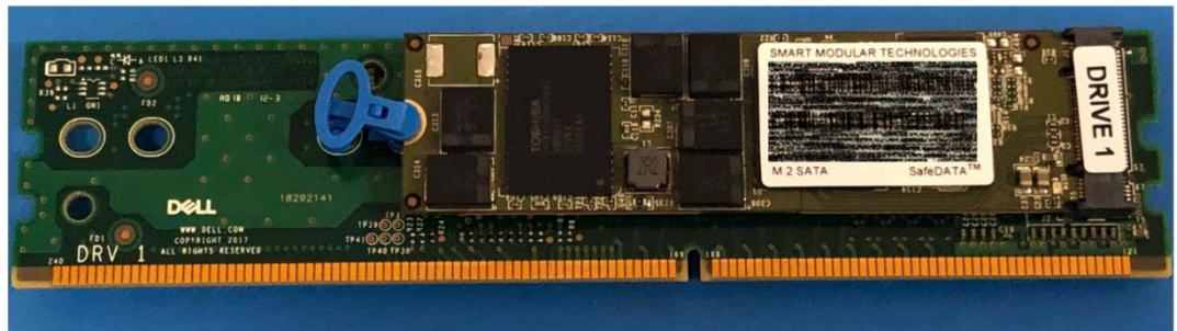
图 13. 内部 M.2 启动模块
