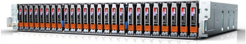
图 1. 完全占满的 VMAX 250FV-Brick DAE
