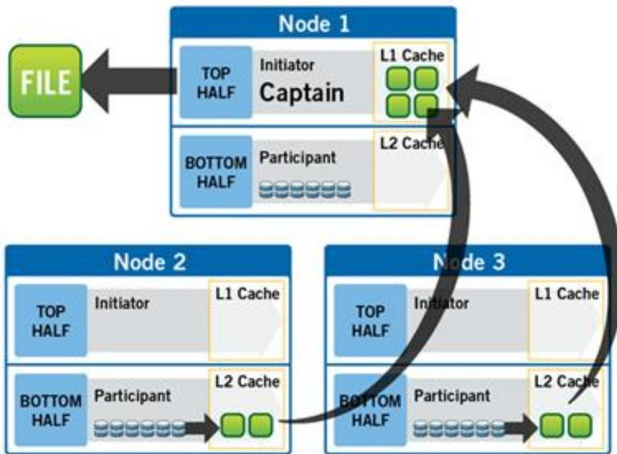
图 12: 3 节点群集中的文件读取操作
