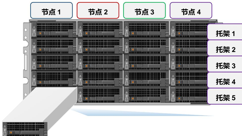
图 18.第 6 代平台机箱前视图显示驱动器托架
