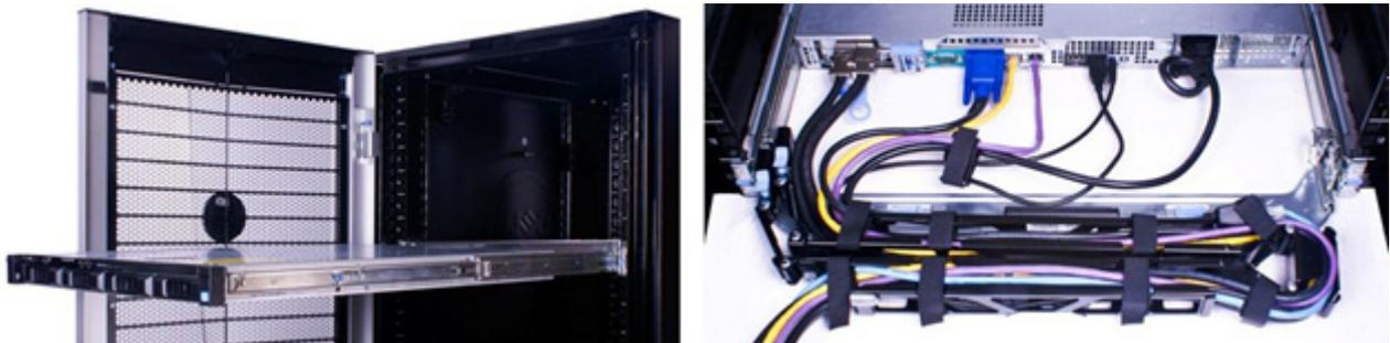
图 13: 使用 CMA 将系统安装在滑动导轨中
