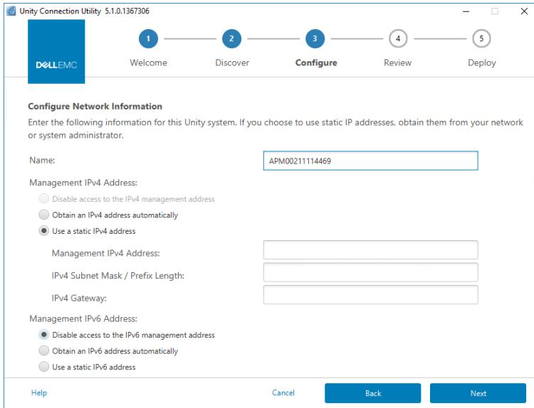
Рис. 3. Настройка IP-адреса в Connection Utility для Unity
