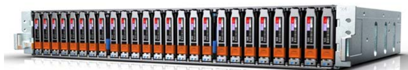
Figura 1. DAE do V-Brick do VMAX 250F totalmente preenchida
