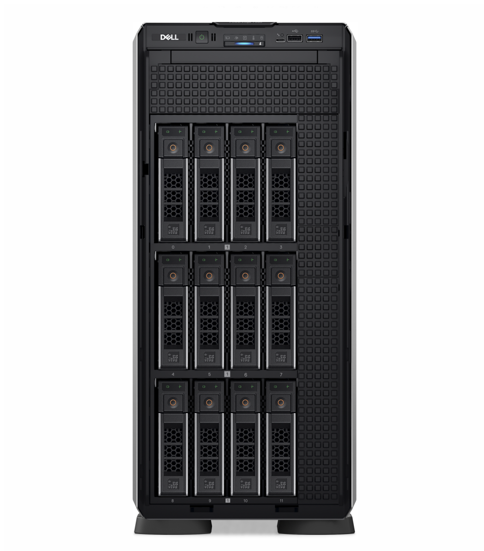
Figura 3. Visão frontal do sistema com 8 unidades de 3,5 polegadas + 8 unidades de 2,5 polegadas
