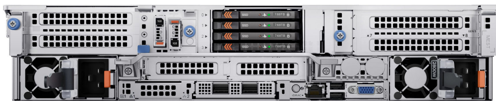
Figura 7. Visão posterior do sistema com 4 sistemas de unidades EDSFF E3.S
