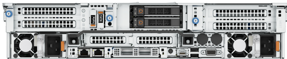
Figura 6. Visão posterior do sistema com 2 unidades de 2,5 polegadas
