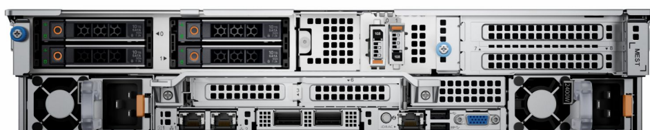
Figura 11. Visão posterior do sistema com módulo de 4 unidades traseiras de 2,5 polegadas
