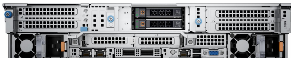
Figura 10. Visão posterior do sistema com módulo de 2 unidades traseiras de 2,5 polegadas
