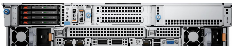
Figura 12. Visão posterior do sistema com módulo de 4 unidades traseiras EDSFF E3.S
