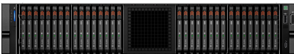
Figura 8. Visão frontal do sistema com 32 unidades E3.S
