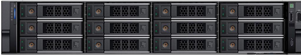
Figura 5. Visão frontal do sistema com 12 unidades de 3,5 polegadas
