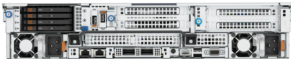
Figura 13. Visão posterior do sistema com módulo de 4 unidades traseiras EDSFF E3.S
