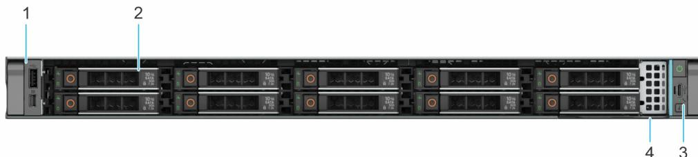
Figura 2. Exibição frontal do sistema com 10 unidades de 2,5 polegadas
