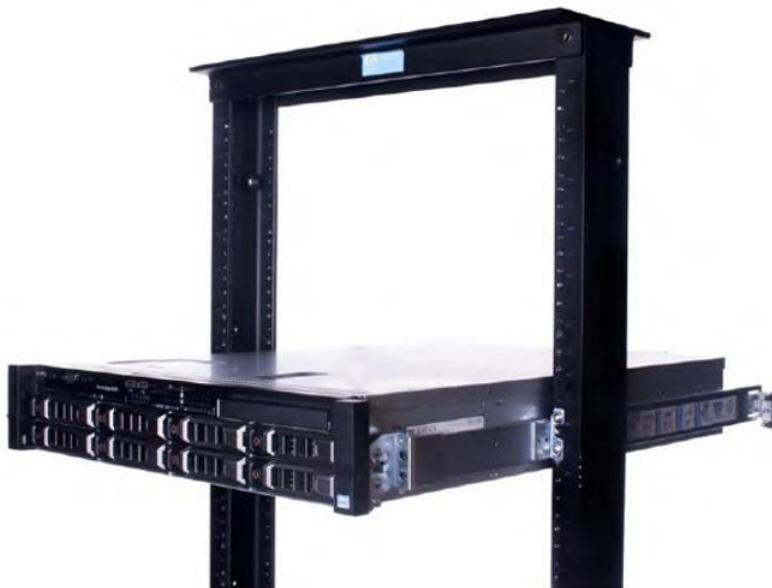
**Figura 39. Trilhos fixos na configuração de montagem central em 2 hastas**
