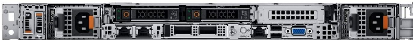
Figura 7. Visão posterior do sistema com sistema de unidade traseira de 2 x 2,5 polegadas
