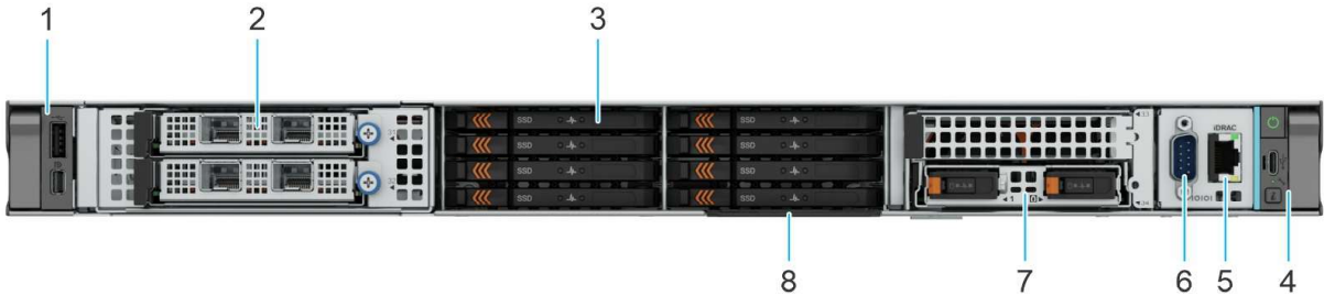
Figura 2. Visão frontal do sistema com 8 unidades EDSFF E3.S e E/S frontal
