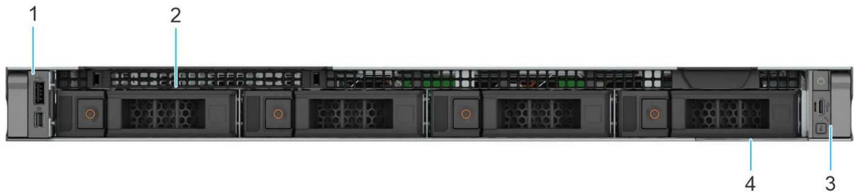
Figura 6. Visão frontal do sistema com 4 unidades de 3,5 polegadas com E/S traseira
