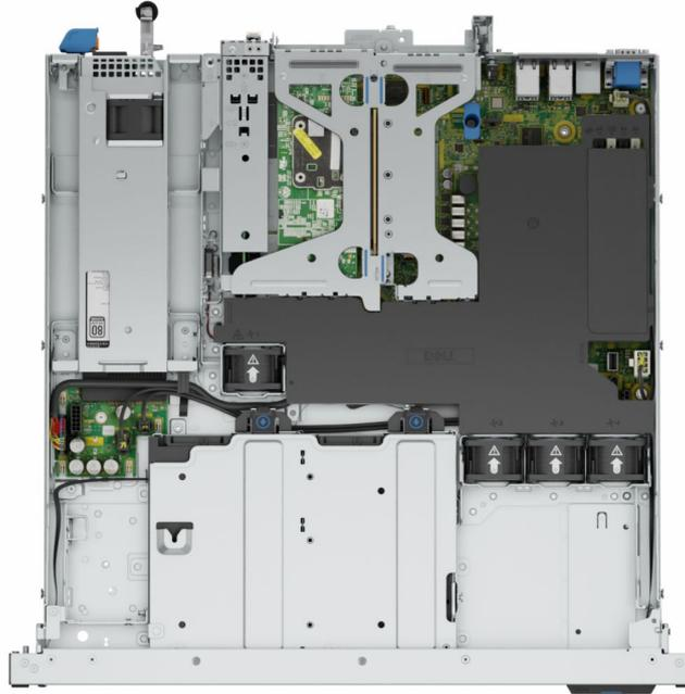
Figura 10. 2 slots PCIe de baixo perfil no riser com 2 unidades de 3,5 polegadas SAS/SATA e PSU não cabeada
