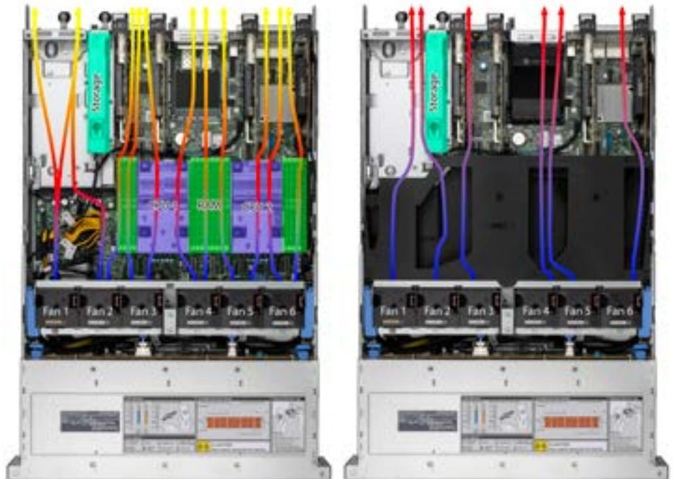
Figura 2: O layout da placa-mãe do Dell PowerEdge HS5620 que testamos, mostrando a camada térmica inferior (esquerda) e a camada térmica superior (direita) que o defletor divide. Adicionamos etiquetas e setas de componentes que mostram a direção do fluxo de ar dos ventiladores, com o ar mais frio indicado por azuis e roxos e o ar mais quente indicado por vermelhos, laranjas e amarelos. Origem: Principled Technologies.
