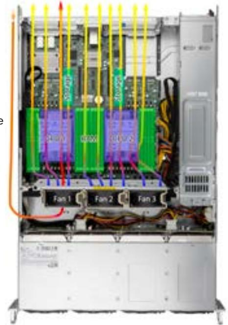
Figura 1: O layout da placa-mãe do Supermicro SYS-621C-TN12 que testamos. Adicionamos etiquetas e setas de componentes que mostram a direção do fluxo de ar dos ventiladores, com o ar mais frio indicado por azuis e roxos e o ar mais quente indicado por vermelhos, laranjas e amarelos. Origem: Principled Technologies.
