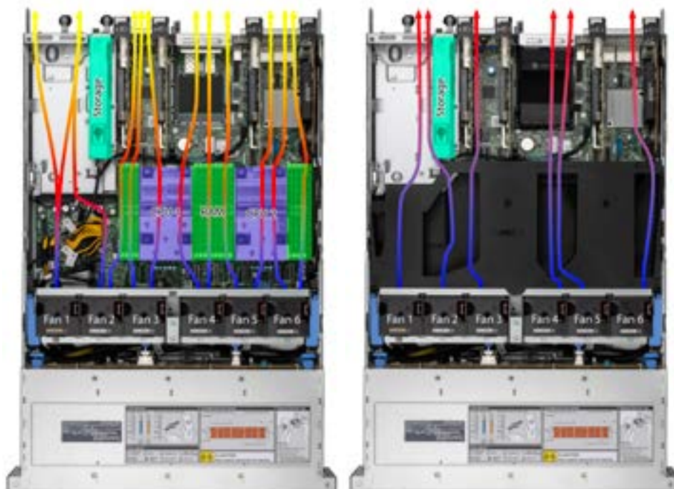
Afbeelding 2: De lay-out van het moederbord van de Dell PowerEdge HS5620 die we hebben getest, toont de onderste thermische laag (links) en de bovenste thermische laag (rechts) die door de mantel wordt verdeeld. We hebben onderdeellabels en pijlen toegevoegd die de luchtstroomrichting van de ventilatoren aangeven, waarbij koudere lucht wordt aangegeven door blauw en paars en warmere lucht wordt aangegeven door rood, oranje en geel. Bron: Principled Technologies.
