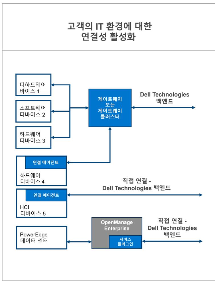
보안 연결 게이트웨이 옵션을 사용하면 Dell 시스템을 게이트웨이에 연결하여 Dell Technologies Services와 다시 통신할 수 있습니다. 이를 통해 방화벽/네트워킹 설정이 간소화되어 게이트웨이만 인터넷을 통해 아웃바운드로 연결됩니다.
