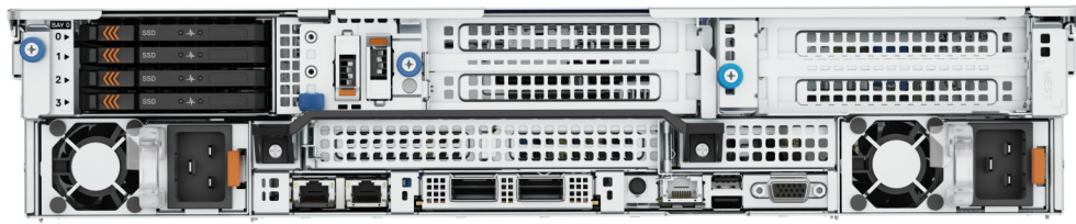
그림 13 . 4개의 EDSFF E3.S 후면 드라이브 모듈이 있는 시스템의 후면
