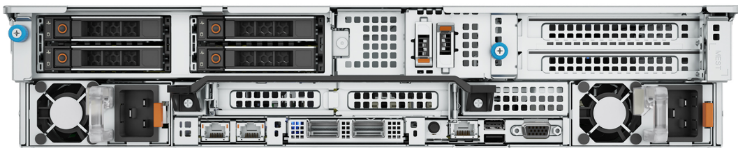
그림 11 . 4개의 2.5" 후면 드라이브 모듈이 있는 시스템의 후면
