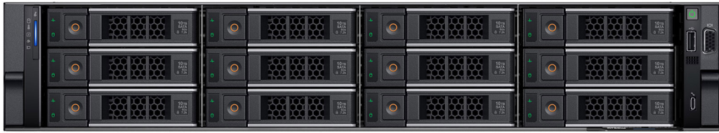
그림 5 . 12개의 3.5인치 드라이브 시스템의 전면
