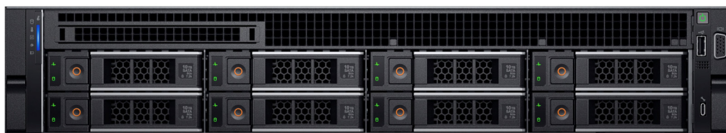
그림 4 . 8개의 3.5" 드라이브 시스템의 전면
