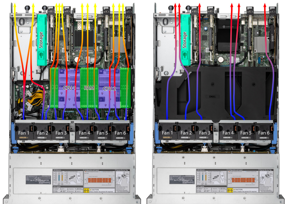
그림 2: 테스트한 Dell PowerEdge HS5620의 마더보드 레이아웃은 슈라우드가 분할하는 하단 열 계층(왼쪽)과 상단 열 계층(오른쪽)을 보여준다. 팬에서 나오는 공기 흐름 방향을 표시하는 구성 요소 레이블과 화살표를 추가했다. 차가운 공기는 파란색과 보라색으로, 뜨거운 공기는 빨간색, 주황색, 노란색으로 표시했다. 출처: Principled Technologies.
