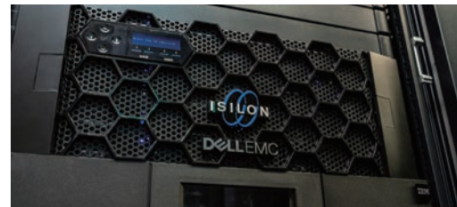
サンジゲンのサーバールームに設置された Dell Precision 3930 ラック型 (上)、 Dell EMC Isilon H400 (下)
