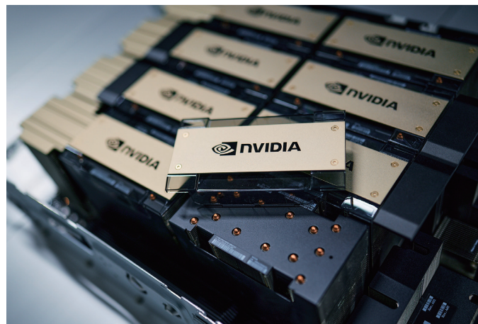
8基のNVIDIA® H100 GPU を搭載可能なPowerEdge XE9680サーバー
