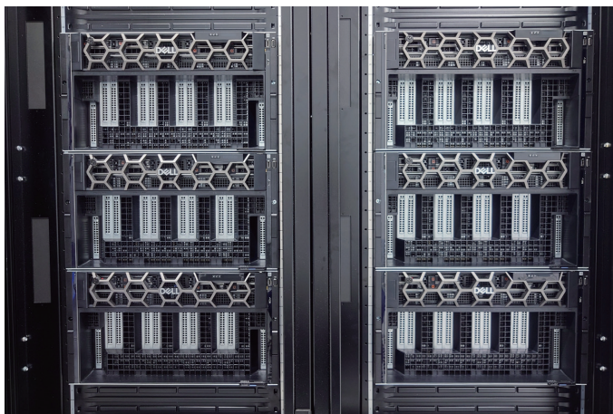
データセンター内の6台のPowerEdge XE9680サーバー
