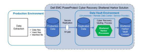
企業ネットワークとバックアップ システムから物理的に分離された専用の環境を構築することで、Sheltered Harbor の参加組織が保護する 必要がある重要なデータ セットを標準化されたフォーマットで保存できます。これにより、顧客向けの基本的な銀行業務を迅速に再開できます。 導入の評価は数か月もかからず数週間で完了し、また Sheltered Harbor 仕様を確実に満たすことができます。
