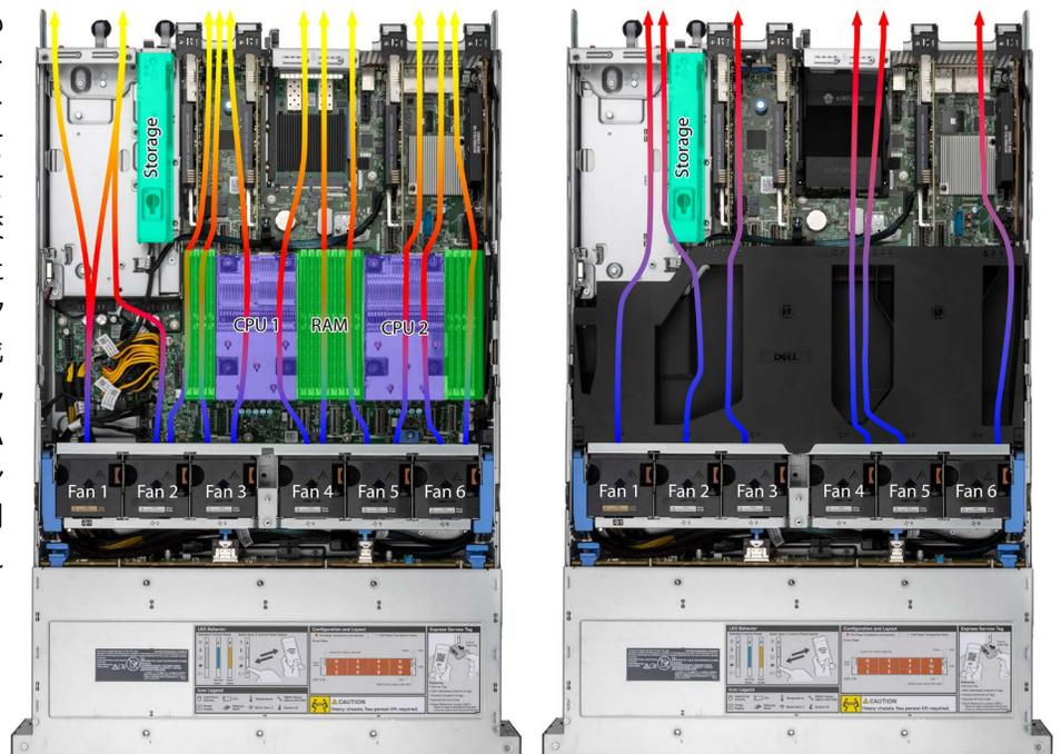
図 2：今回テストした Dell PowerEdge HS5620 のマザーボードのレイアウト。底部の熱層 (左) と上部の熱層 (右) がシュラウドで分割されている。各コンポーネントを示すラベルと、ファンからのエアフロー方向を示す矢印を追加。低温の空気は青と紫、高温の空気は赤、オレンジ、黄色で図示。出典：Principled Technologies。
