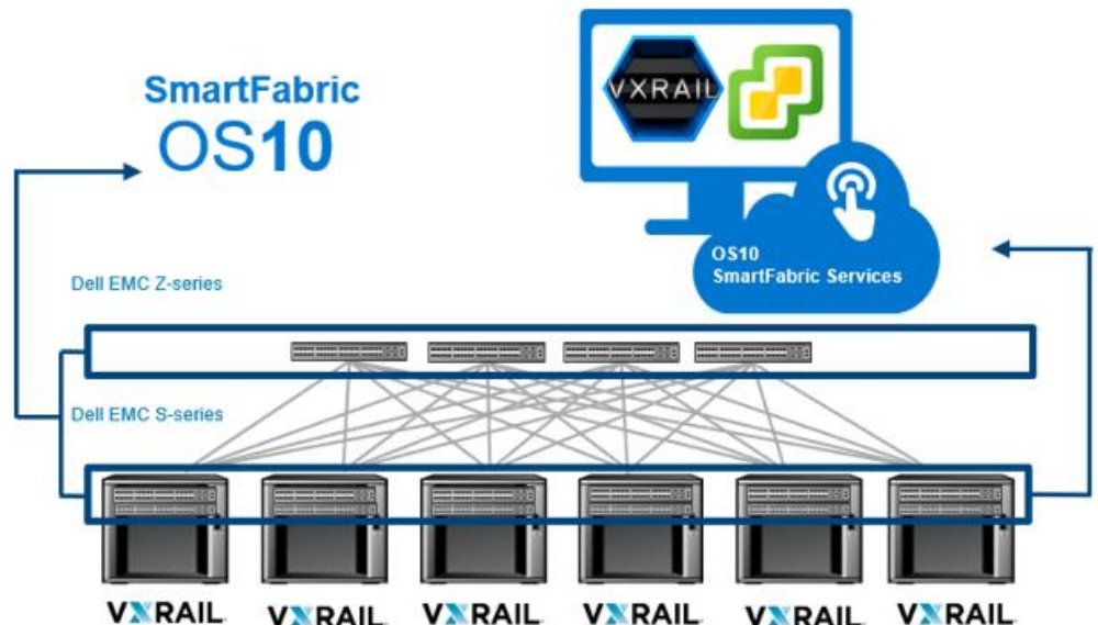
図 21 : SmartFabric サービスを使用した VxRail
