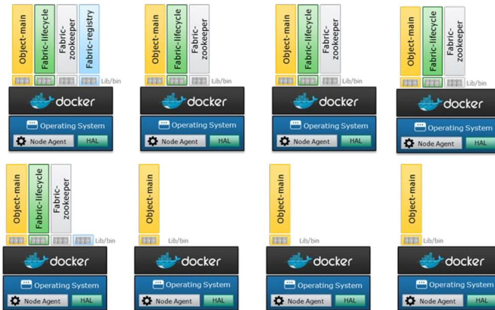
Figura 13 Esempio di container e agent di Docker in un deployment a otto nodi
