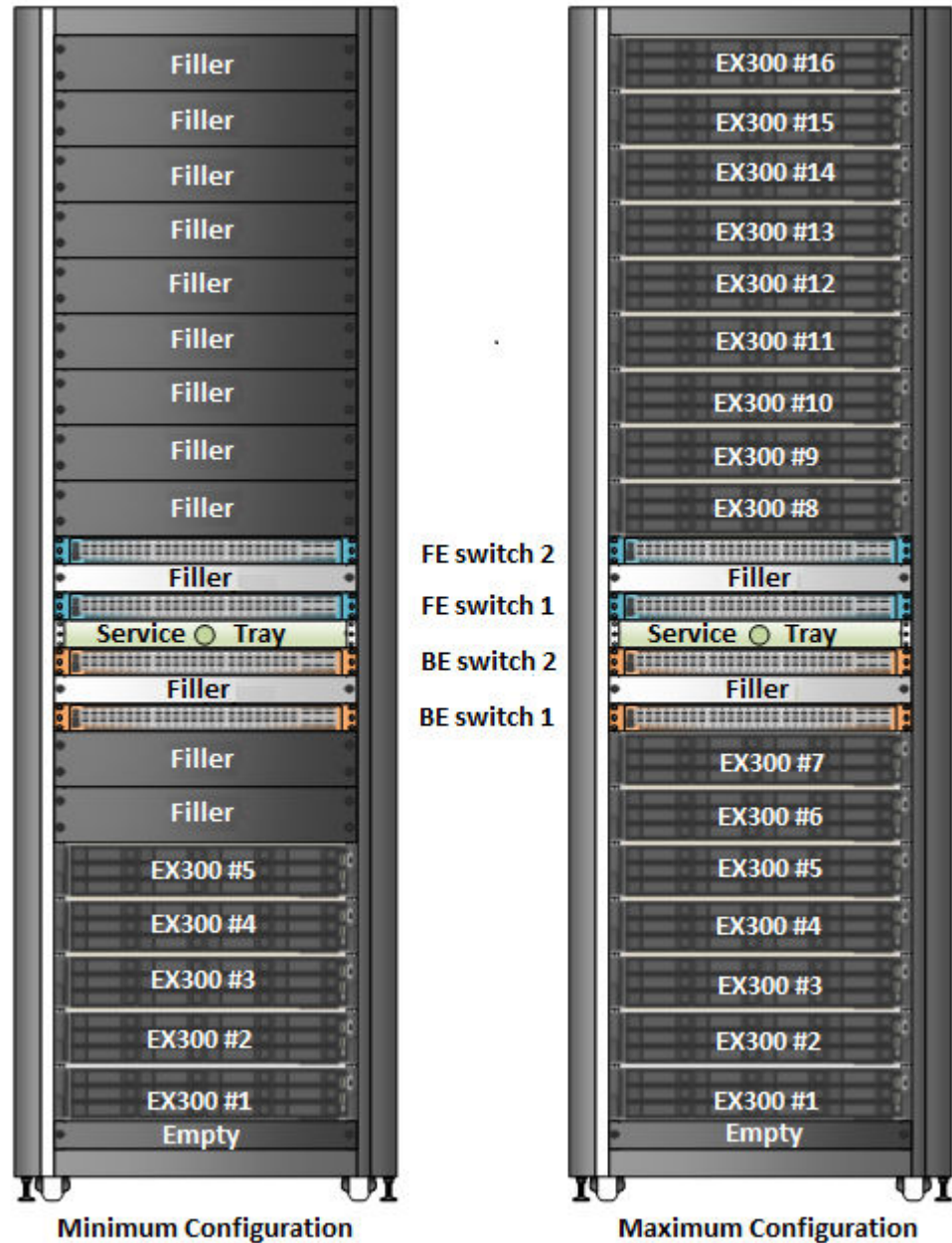
Figure 7 Configurations minimum et maximum de l'appliance EX300
