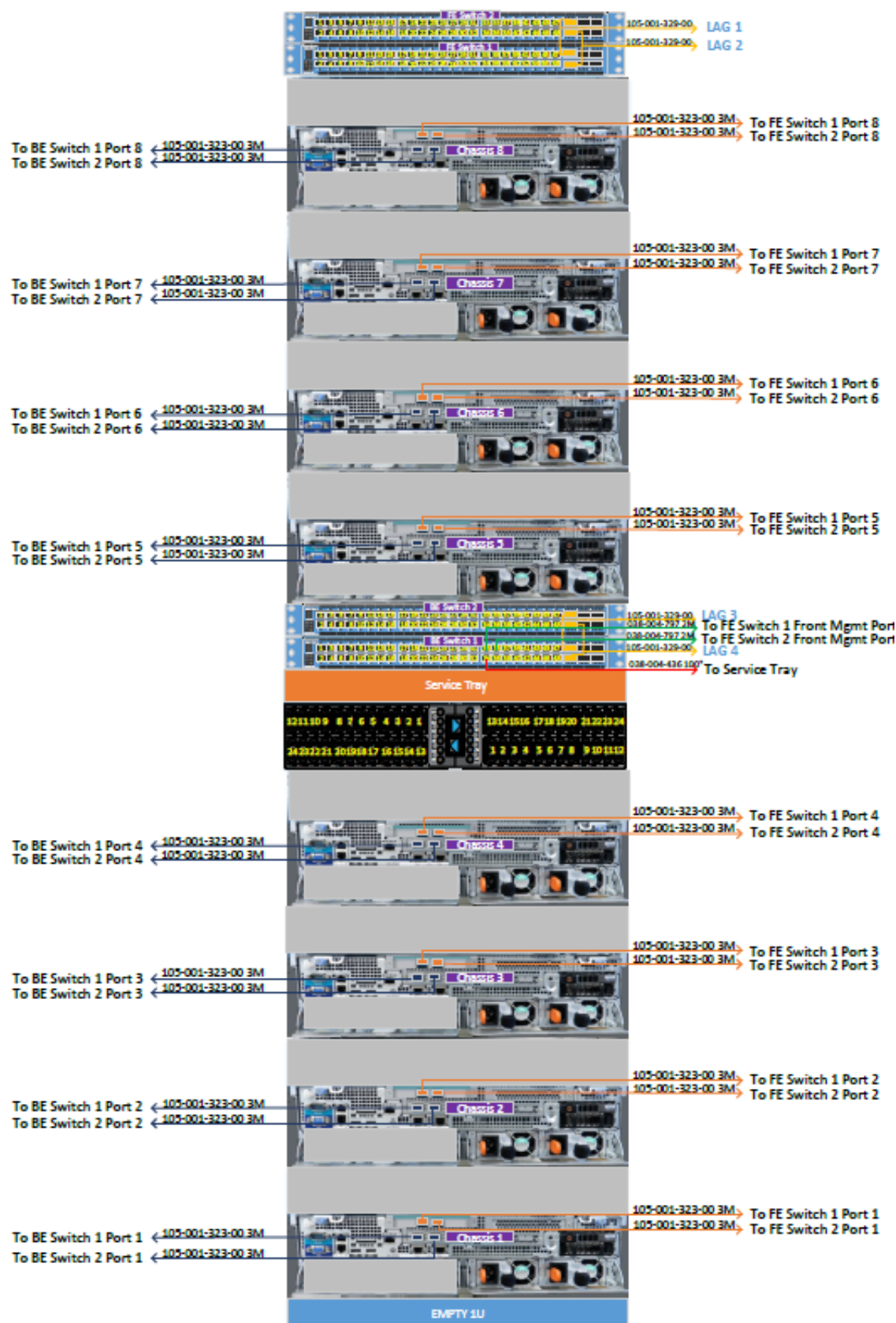
Figure 59 Câblage réseau de l'appliance EX3000S
