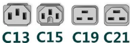
Figure 13. Connecteur du cordon d'alimentation du bloc d'alimentation
