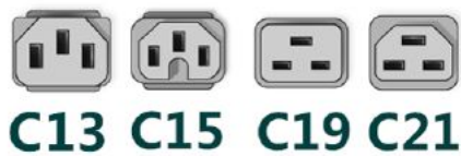
Figure 33. Câbles d'alimentation du bloc d'alimentation
