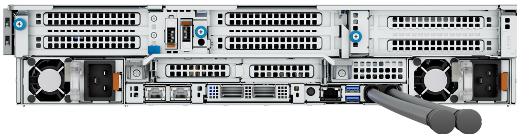
Figure 8. Vue arrière du système avec refroidissement liquide en option
