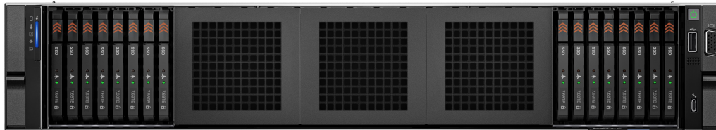
Figure 5. Vue avant d'un système à 16 disques NVMe EDSFF E3.S Gen5
