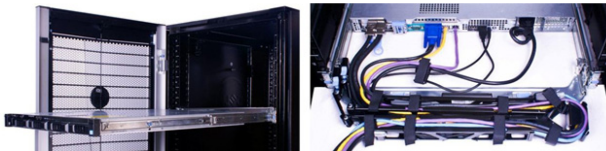
Figure 13. Système monté sur rails coulissants avec le bras CMA
