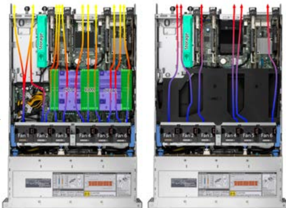
Figure 2 : Disposition de la carte mère du Dell PowerEdge HS5620 que nous avons testé, montrant la couche thermique inférieure (à gauche) et la couche thermique supérieure (à droite) que le carénage divise. Nous avons ajouté des étiquettes de composants et des flèches indiquant la direction du flux d'air en provenance des ventilateurs. L'air plus froid est indiqué par des flèches bleues et violettes, et l'air plus chaud est indiqué par des flèches rouges, orange et jaunes. Source : Principled Technologies.
