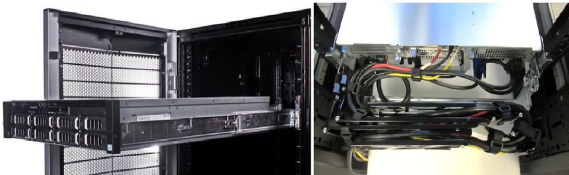
**Figure 38. Rails coulissants avec câblage par bras CMA**
