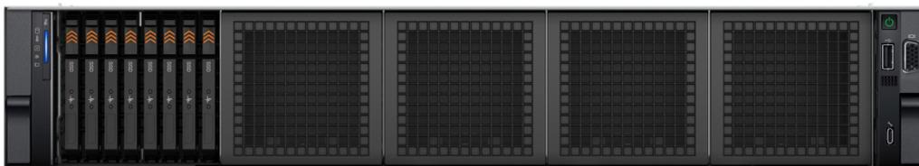
Figure 8. Vue avant d'un système doté de 8 disques EDSFF E3.S
