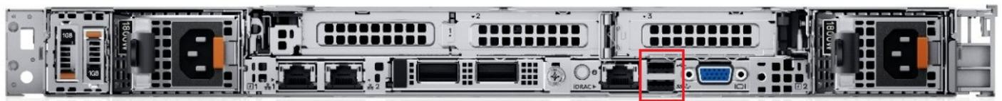
**Figure 43. Ports USB arrière du système R6615**
