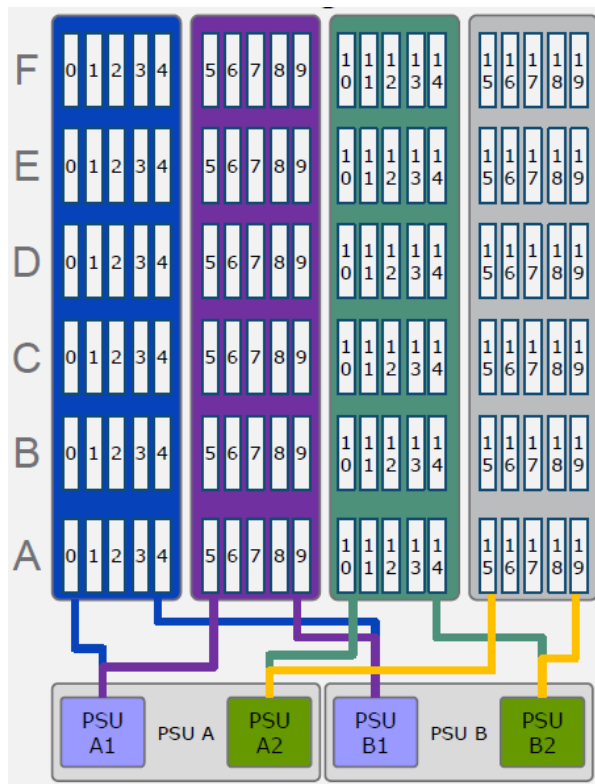
Figura 2. Diseño del DAE de brick del VMAX 450F y del VMAX 850F: slots de unidades y zonas de alimentación
