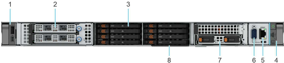
Ilustración 2. Vista frontal de un sistema de 8 unidades EDSFF E3.S con I/O frontal
