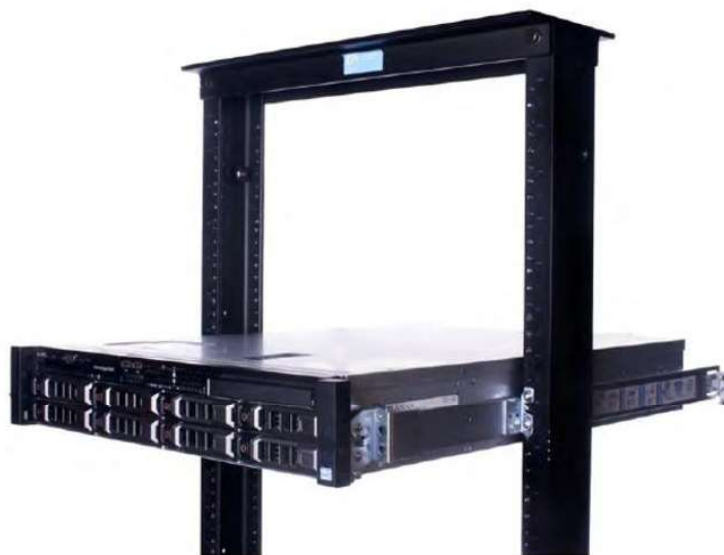
Ilustración 38. Rieles estáticos en una configuración de 2 postes de montaje central
