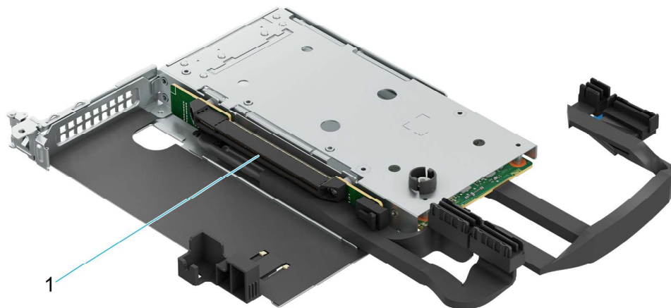
Ilustración 26. Tarjeta elevadora R2u
